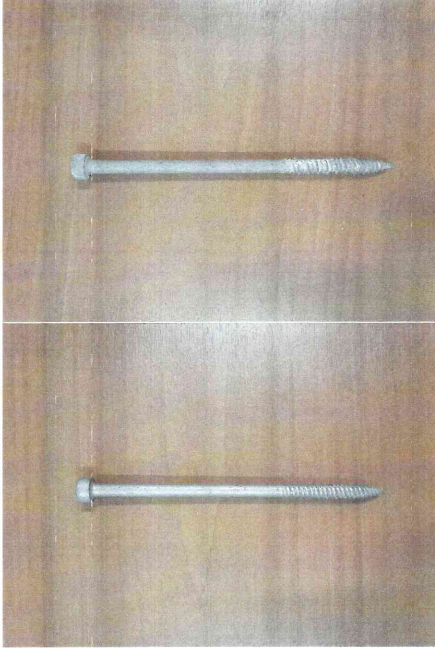
Приложение А. Образцы до и после выдержки в камере соляного тумана 1000 ч.
